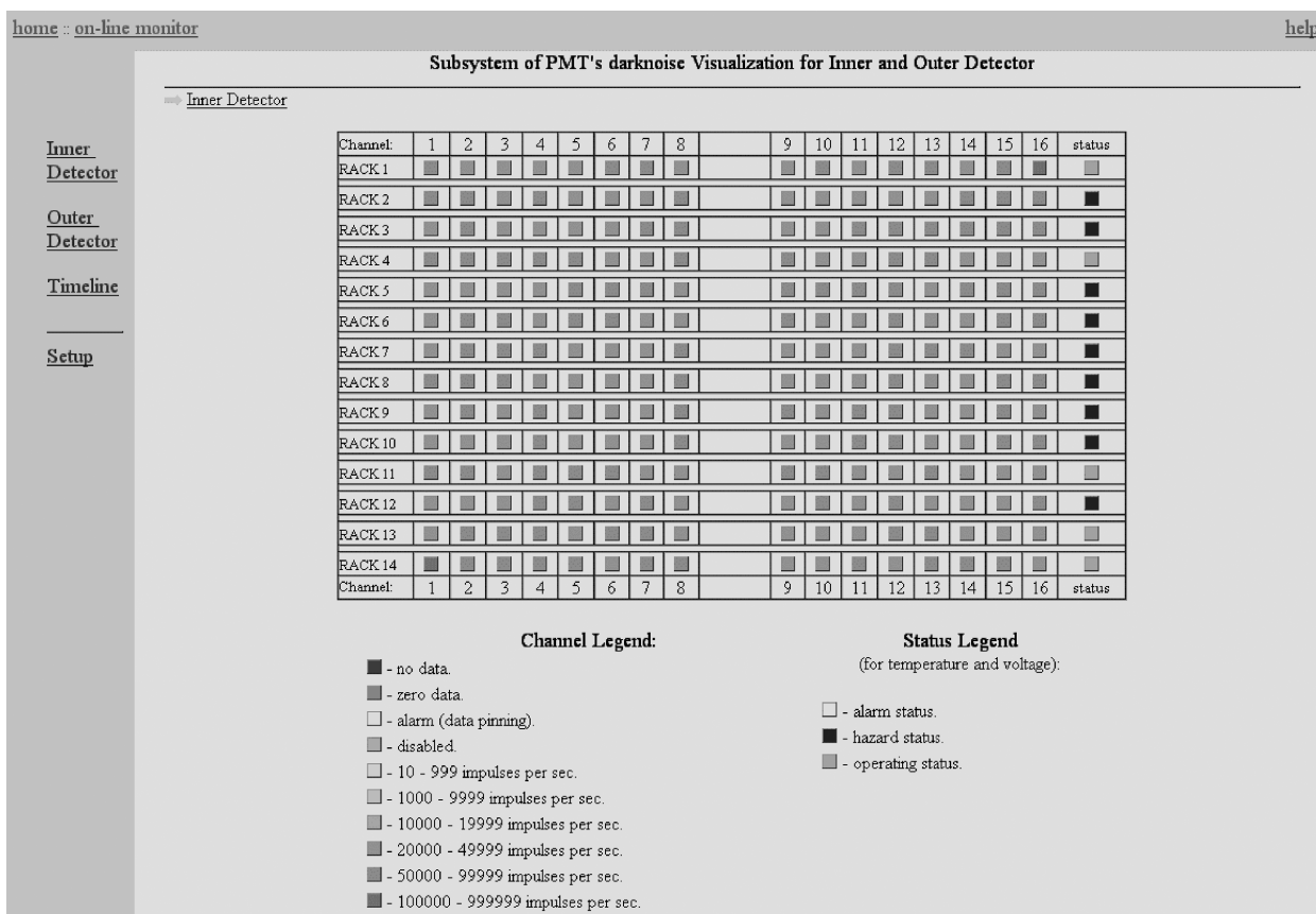
Рис. 4. Пример экрана контроля состояния каналов (channel) для одной подсистемы (Inner Detector) частотомеров (rack).
