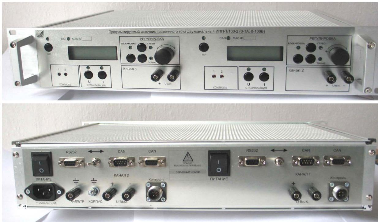
**Программируемые источники тока предназначены для построения распределенных систем питания электромагнитных элементов.**
